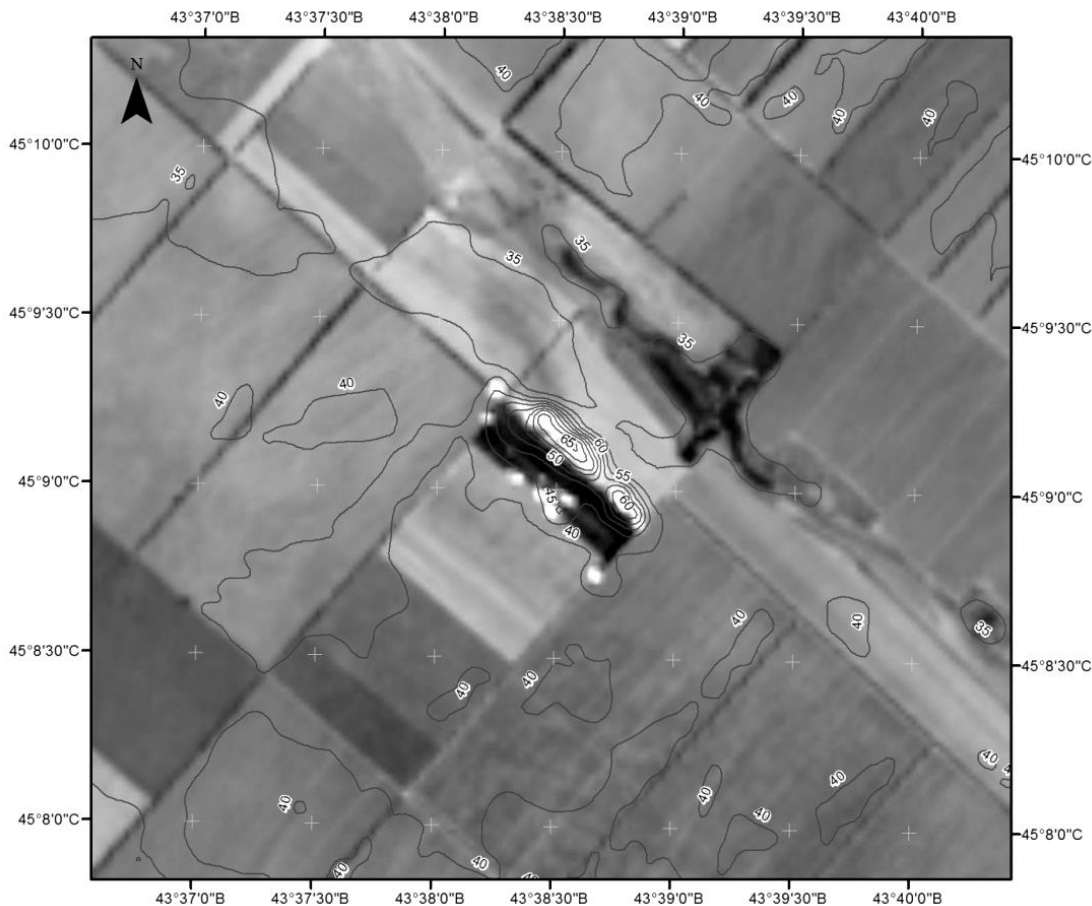
Фрагмент космического снимка Landsat-8, комбинация каналов 7–6–4, с наложенными контурами показателей температуры, °C / Satellite image Landsat-8, a combination of channels 7-6-4, with superimposed circuits of temperature indicators, °C
